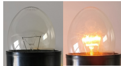
Abb. 4: Glühlampe, aus (links)/an (rechts)
