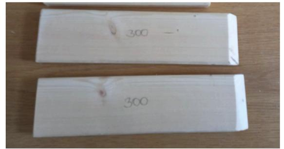
Abbildung 2: zugesägte äußere Rahmenteile im Gerungsschnitt
