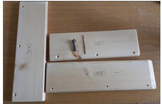
Abbildung 6: vorgebohrte und angesenkte äußere Rahmenteile
