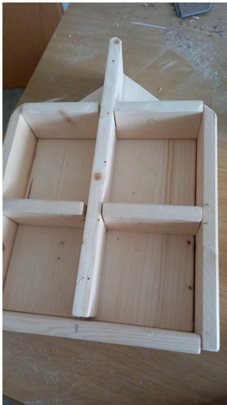
Abbildung 9: vertikales Einlege­teil in das horizontale Teil eingesteckt
