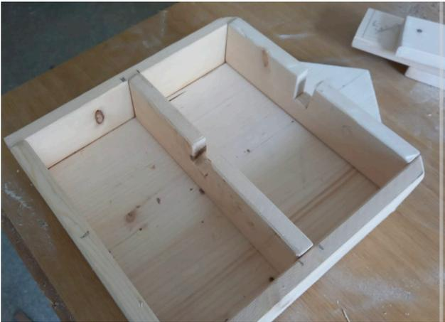
Abbildung 8: horizontale Einlege­teile an den Rahmenteilen verschraubt
