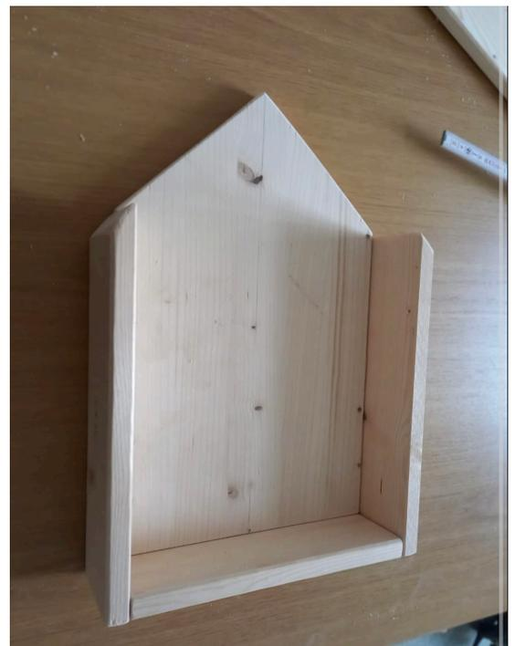
Abbildung 7: äußere Rahmenteile an der Grundplatte angeschraubt
