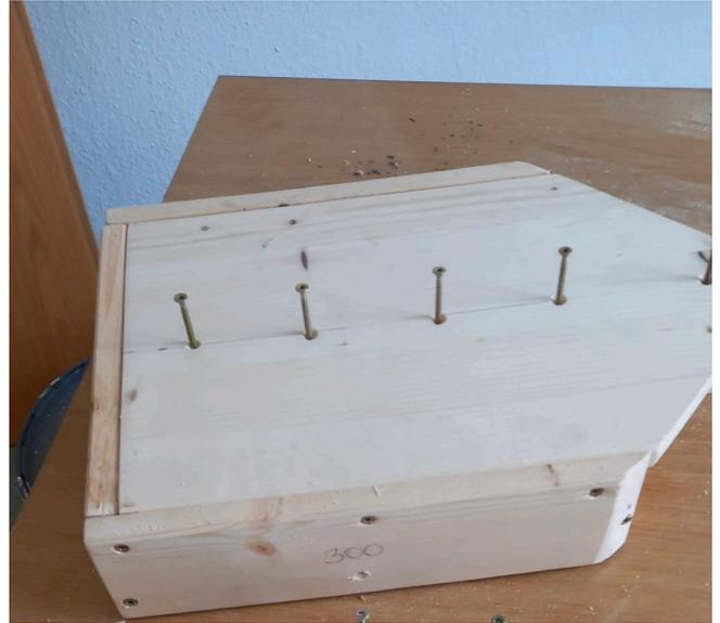
Abbildung 10: Verschraubung des vertikalen Einlege­teils an der Grundplatte
