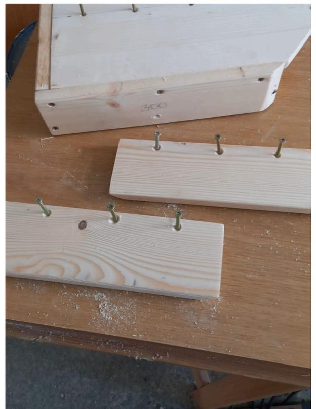
Abbildung 11: Dach­teile zur Verschraubung vorbereitet
