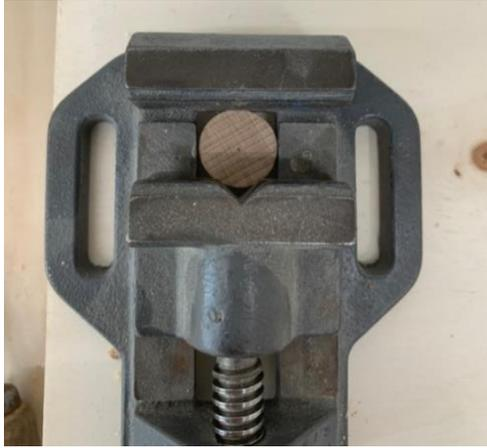
Abbildung 15: Korrektes Einspannen des Rads in den Schraubstock zum Bohren
