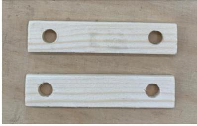
Abbildung 6: Radbefestigungen am Ende von Schritt 4 mit Bohrlöchern
