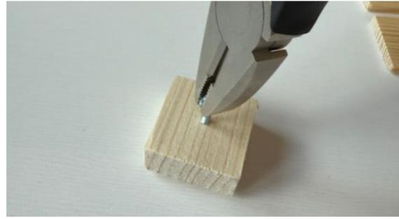
Abbildung 8: Eindrehen des Schraubhakens mit einer Zange
