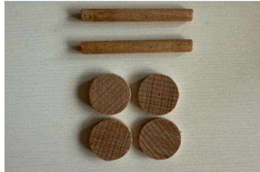
Abbildung 13: Zugesägte Räder und Radlager am Ende von Schritt 7
