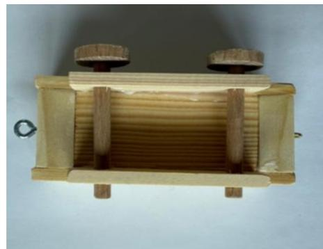
Abbildung 18: Durchstecken der Radlager durch die unteren Seitenleisten
