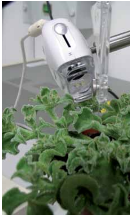
Das Potsdamer Laser-Fluorometer kann mit optischen Sonden Sauerstoff auch in grünen Pflanzenteilen messen.
